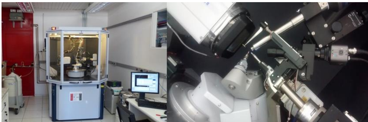
Figura 2.3: Difratorômetro Bruker Kappa APEX II Duo do Instituto de Química/Unicamp.
