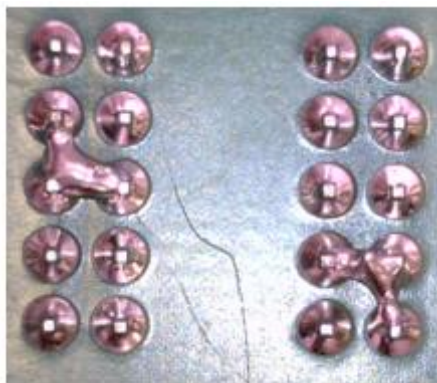
Figura 4.1 – Incidência de curto circuito de solda, sem nenhum recurso aplicado.
