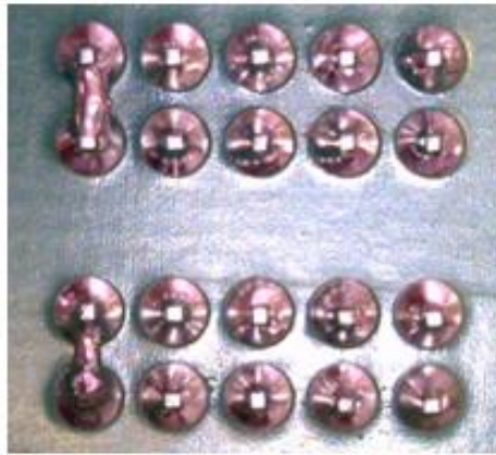
Figura 4.2 – Diminuição do curto circuito de solda na posição do componente.
