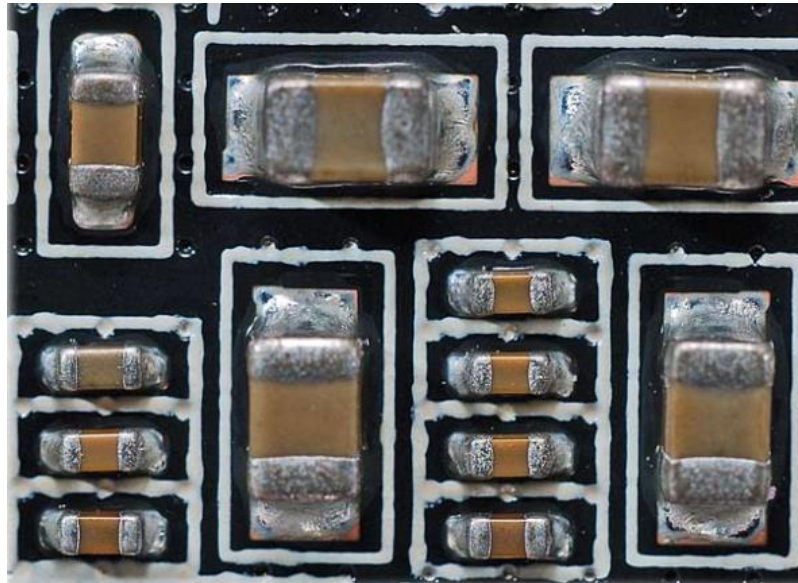
Figura 2.22 – Componentes SMD soldados por refusão.
