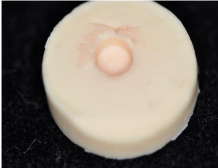
Fig. 18 – Matriz de polivinilsiloxano para confecção dos espécimes de infiltrante
