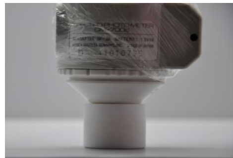
Fig. 11 - Dispositivo para leitura de cor acoplado ao espectrofotômetro
