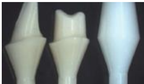
Figura 21-Pilares de Zircônia: Inciso, Pré-molar e pilar de teste (da esquerda para direita). FONTE: ALBRECHT,2011
