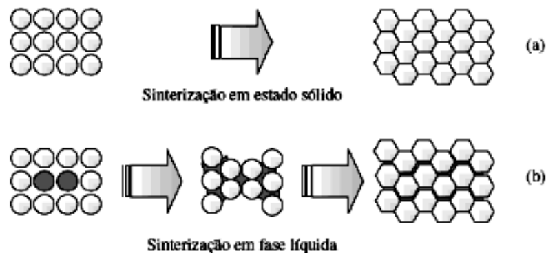
Figura 9 - (a) Sinterização em estado sólido; (b) Sinterização em fase Líquida FONTE: BARSOUM, 1997
