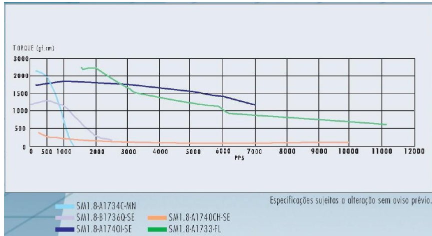
Figura C.2 - Curva característica Torque/Velocidade dos motores de passo da série SM1.8 – NEMA 17.
