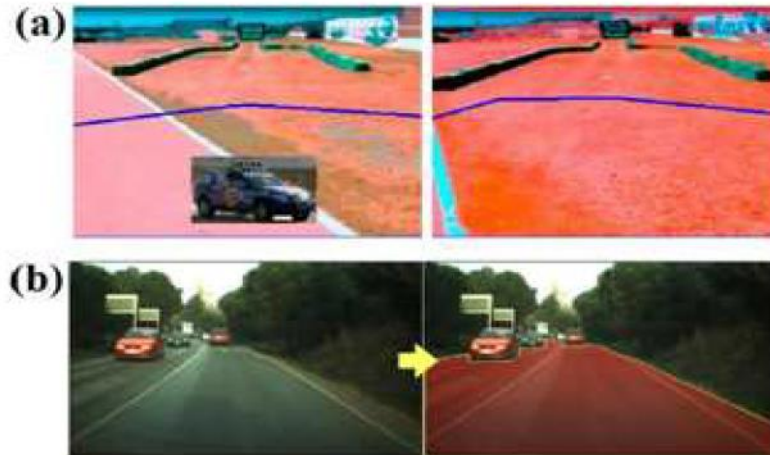
Figura 1.5 - Espaço Navegável: (a) Sistema Multisensor Laser / Visão (DAHLKAMP, 2006); (b) Sistema baseado em Visão (ÁLVAREZ & LOPEZ, 2011).
