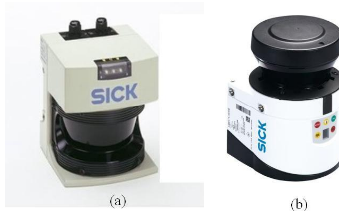
Figura 3.5 – Scanner a Laser tipo industrial da marca SICK: (a) LMS 291 ( outdoor , campo de visão: 180°; resolução angular: 0,25°, 0,5° e 1°; alcance: 30 m); (b) LMS 111 ( outdoor , campo de visão: 270°; resolução angular: 0,5° e 1°; alcance: 20 m).
