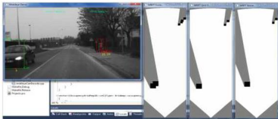
Figura 1.7 - Resultados da fusão de grades de ocupação tipo pessimista, em ambiente dinâmico, a partir de dados obtidos por uma câmera Mobileye .
