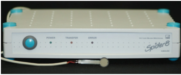
Figura 3 – Equipamento analítico de registro e amplificação do sinal emitido pelo sensor para o registro de força Spider 8 (HBM do Brasil, São Paulo, Brasil).
