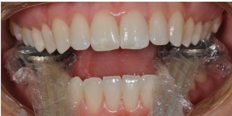
Figura 5 – Sensores (FSR No151, Interlink Electronics Inc., Echternach, Luxembourg) para registro da força máxima de mordida em posição.
