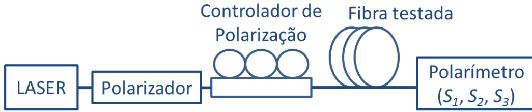
Figura 5.5 – Diagrama de blocos do sistema medidor de DGD utilizando o método do arco de Poincarè.
