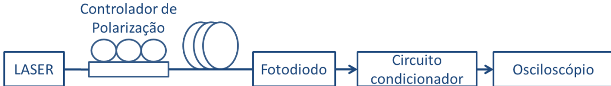
Figura 5.1 – Sistema utilizado para medição de PMD através do método do atraso diferencial de pulsos ópticos.
