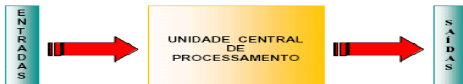
Figura 28 - Esquema de funcionamento de um CLP
