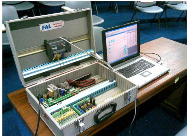
Figura 47 - Maleta Koyo utilizada para testar o programa implementado.
