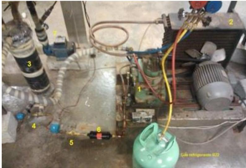
Figura 3.3: Esquema do sistema de refrigeração, por compressão a vapor.
