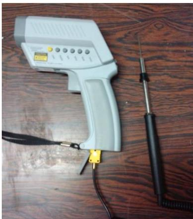
Figura 3.12: Termômetro infravermelho.
