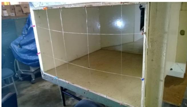
Figura 3.8: Seção de saída do túnel de vento.
