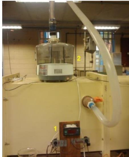
Figura 3.4: Termostato e umidificador.
