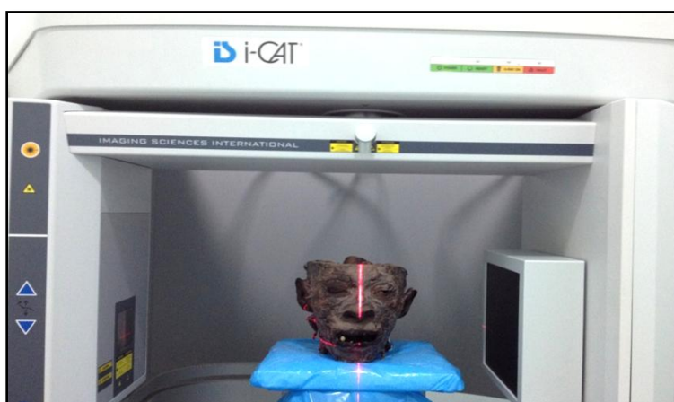
Figura 3. Cabeça posicionada no tomógrafo para aquisição da imagem (padrão-ouro).
