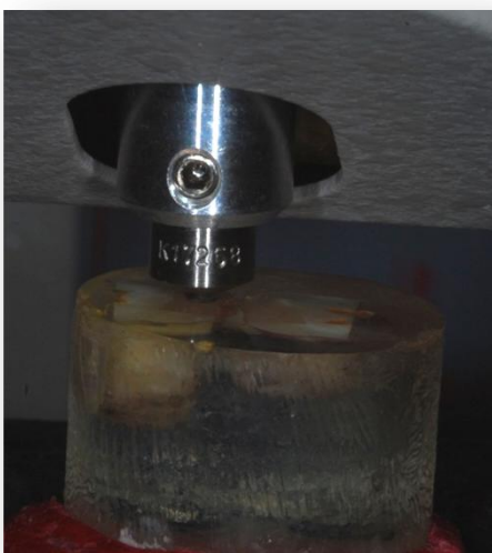
Figura 23: Ensaio de microdureza Knoop com 3 indentações em 3 níveis de profundidade.
