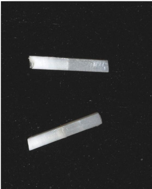
Figura 18: Obtenção de palitos com 0,9x0,9 mm
