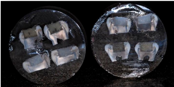
Figura 29: Amostras recobertas com carbono para avaliação em MEV
