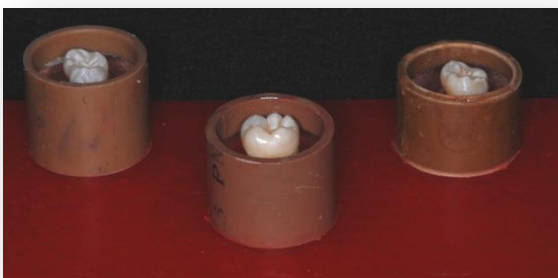
Figura 6: Dentes incluídos em resina de poliestireno utilizando tubos de PVC com diâmetro de 2,5 cm
