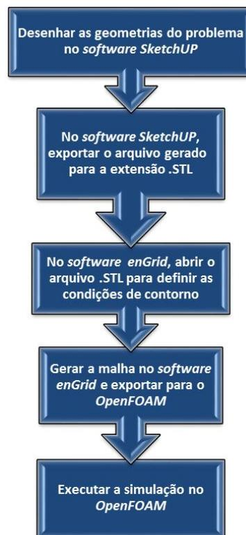
Figura 26 - Sequência do processo de simulação.
