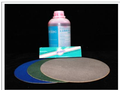
Figura 16: Materiais utilizados para o polimento: feltros, pasta de diamante e óleo lubrificante.
