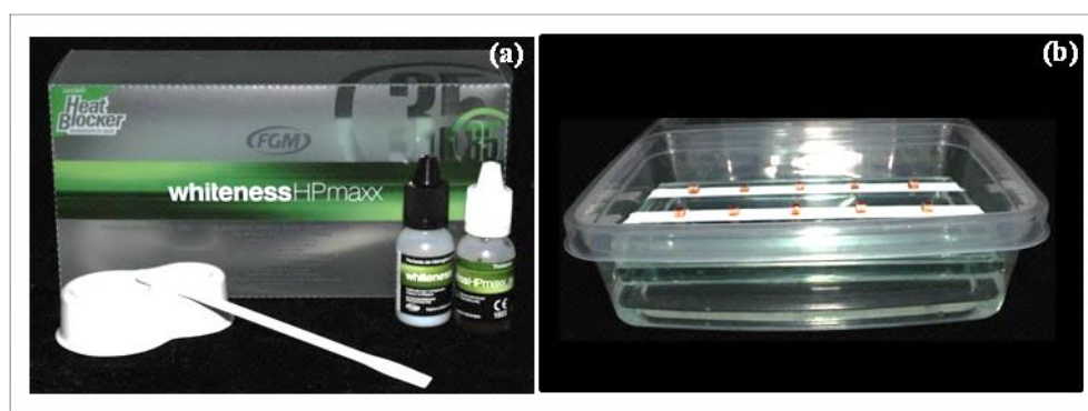
Figura 13: Utilização do peróxido de hidrogênio 35%: (a) gel clareador; (b) forma de armazenamento durante o tratamento do produto sobre os espécimes.
