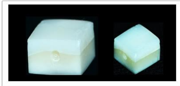
Figura 5: Amostras com marcação em umas das faces laterais com ponta diamantada esférica nº 1012.
