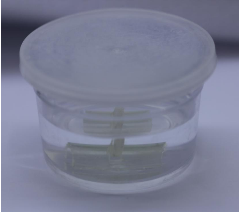
Fig. 4 – (A) confecção da amostra; (B) matriz utilizada; (C) imersão da amostra em água.
