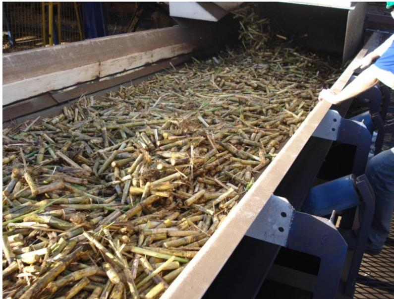
**Figura 22:** Colmo + impurezas não separadas pelo sistema de limpeza.
