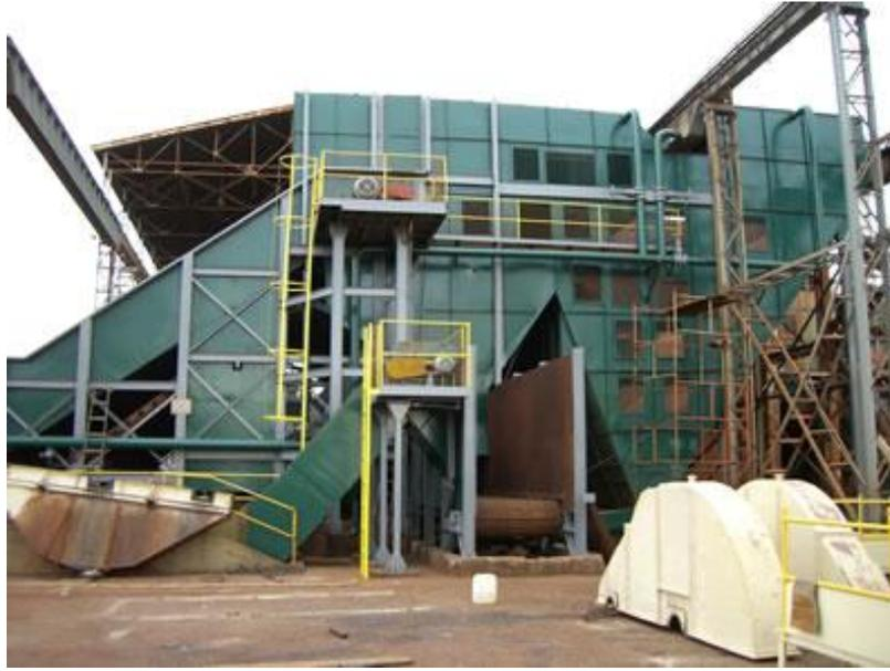
**Figura 12:** Sistema de Limpeza – Usina Guaíra.
