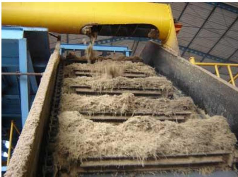
**Figura 24:** Bagaço após sistema de extração.
