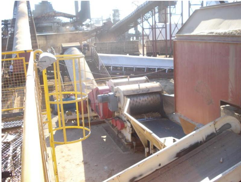
**Figura 20:** Picador de palha – Usina Cerradinho.
