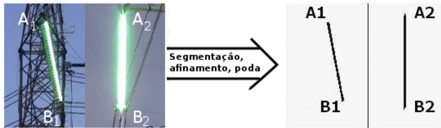
Figura 4.17: Na figura à esquerda é mostrado um par de imagens de arcos elétricos. Na figura à direita tem-se a segmentação destes arcos. (A_1, B_1) e (A_2, B_2) são pares de homólogos.
