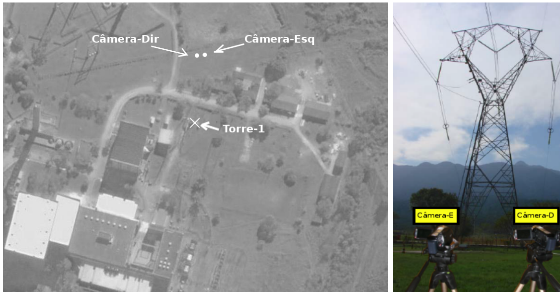
Figura 7.11: Esboço da planta baixa do laboratório de testes do CEPEL. No detalhe: o posicionamento aproximado das câmeras.
