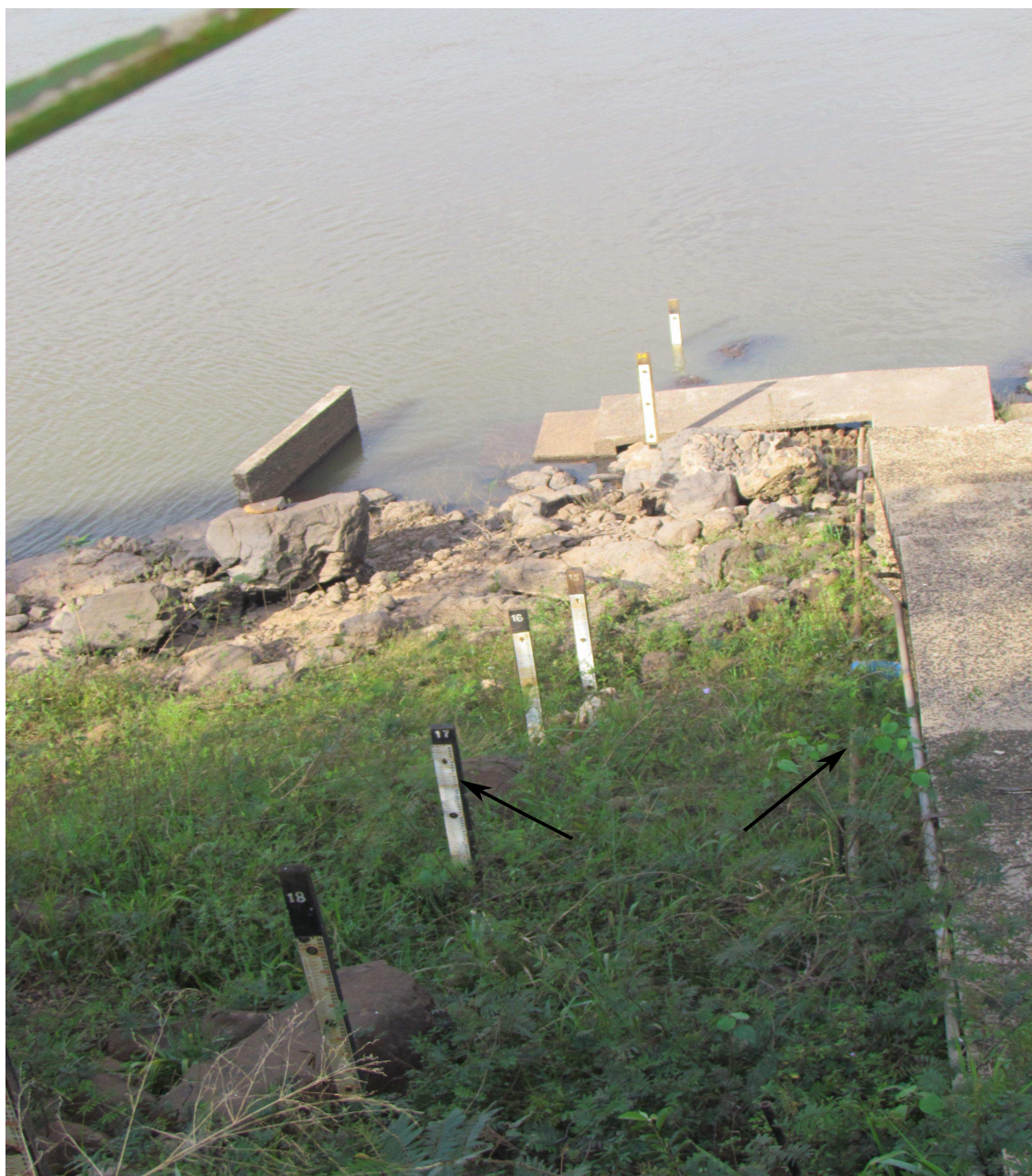
Figura D.4: Monitoramento de níveis por leitura de régua limnimétrica e sensor de nível.
