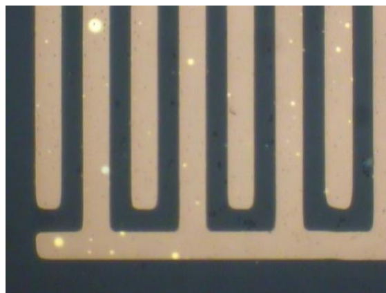
Figura 67 - Pequenas falhas observadas no filme de passivação.
