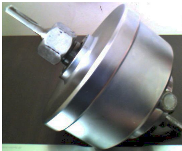
Fig. 3.18 – Dispositivo para furo quadrado sem necessidade de máscara guia
