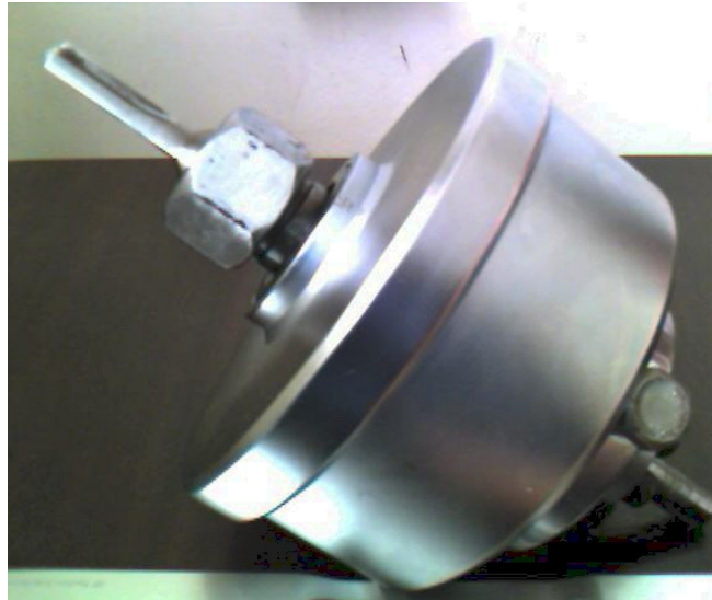
Fig. 2.5- Dispositivo para obtenção de furo quadrado sem utilização de máscara guia
