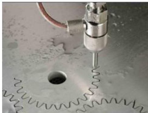
Fig. 2.28 – Corte por jato de água (PERY)
