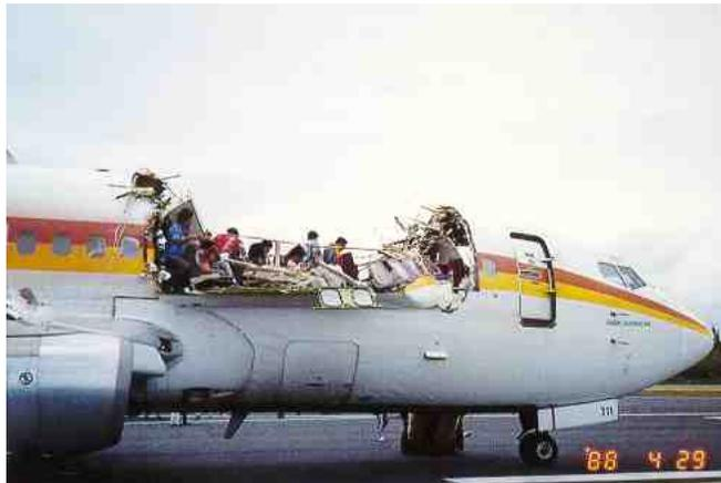
Figura 1.2: Aeronave da Aloha Airlines após o vôo 243, em 1988
