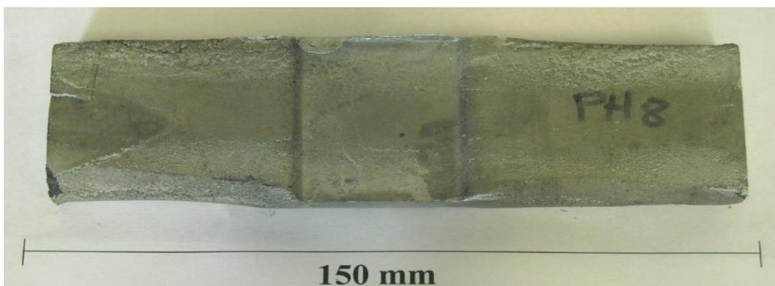
Figura 3.13: Corpo de prova após sofrer a tixoconformação na prensa pneumática
