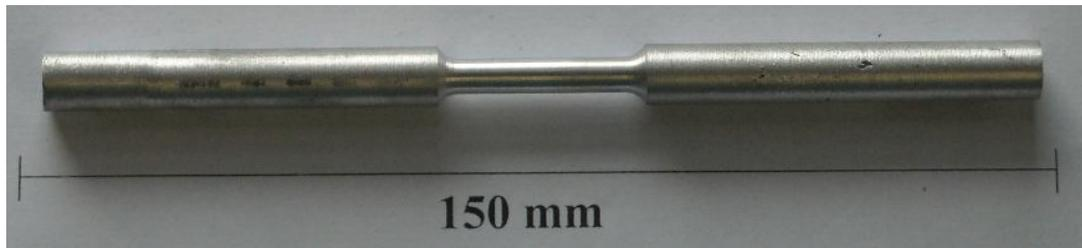
Figura 3.15: Corpo de prova previamente usinado
