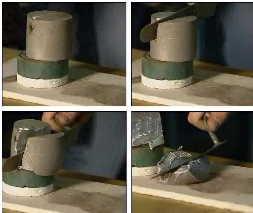
Figura 2.1: Comportamento da liga A366 no estado semi-sólido (ATKINSON, 2005).
