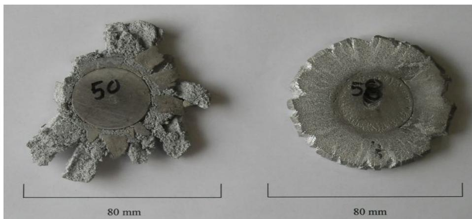
Figura 3.7: Liga Tixoformada de Al-6%-Si-5%Zn com 55% e 45% de fração sólida respectivamente;
