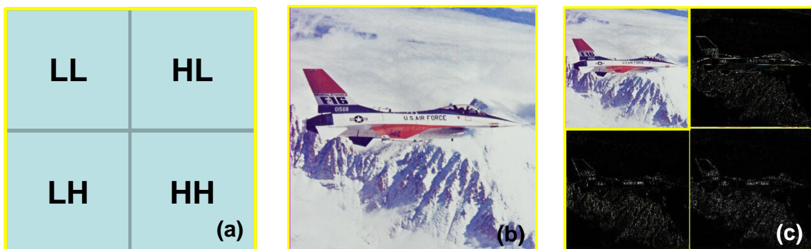
Fig. 2.2. Quadrantes de frequência da TWD aplicada a uma imagem; a) os quatro quadrantes LL , HL , LH e HH ; b) imagem original; c) TWD da imagem em um nível.
