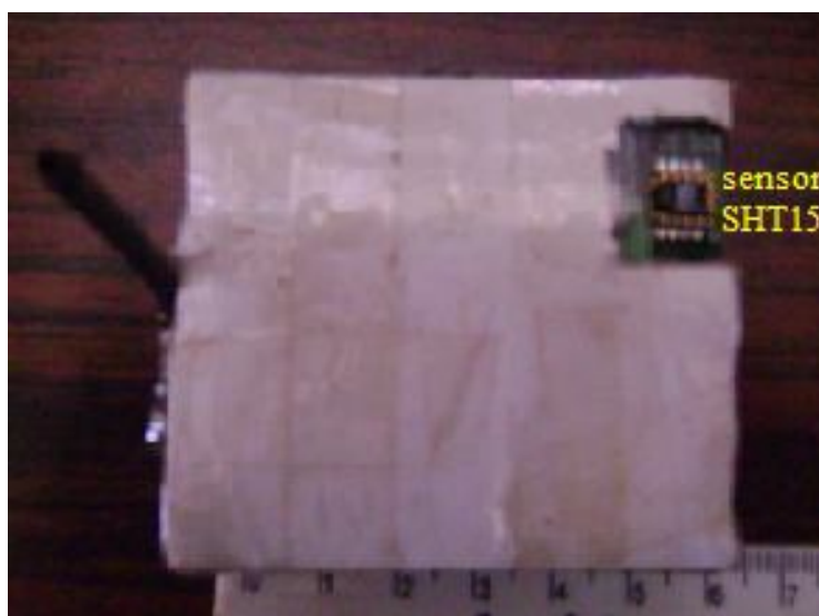
Figura 20: Placa de aquisição MDA300CA com proteção na parte superior.
