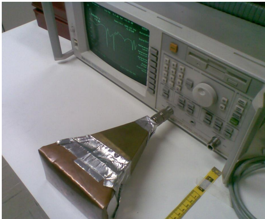
Figura 3.9: APEX - Setup de medidas de perda por retorno.
