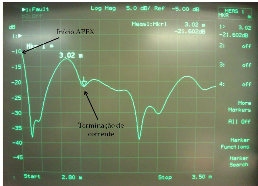
Figura 5.10: Resposta da técnica FDR em função da carga de entrada.
