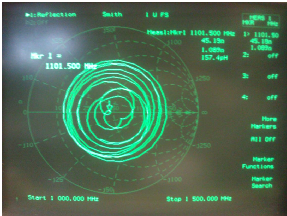
Figura 5.22: Indicação de casamento de impedância na carta de Smith: mostra o casamento ideal em 1 GHz.
