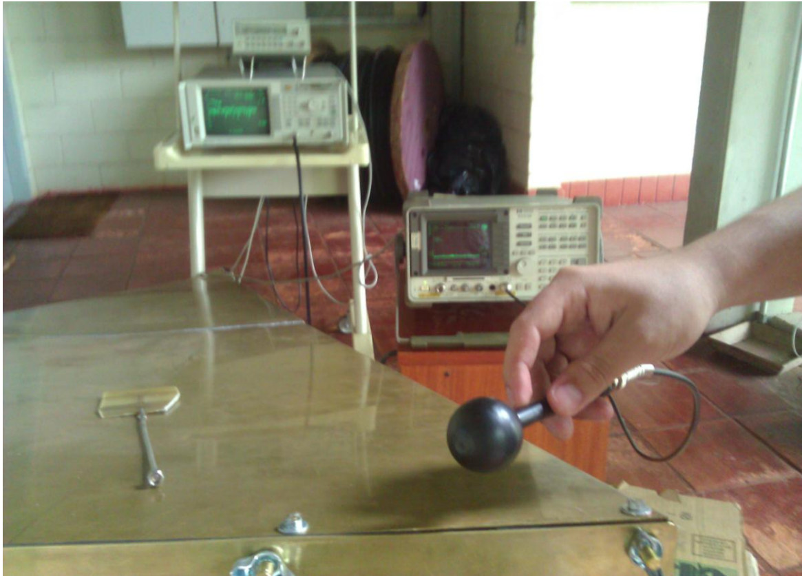
Figura 5.20: Teste de “vazamento” de RF.
