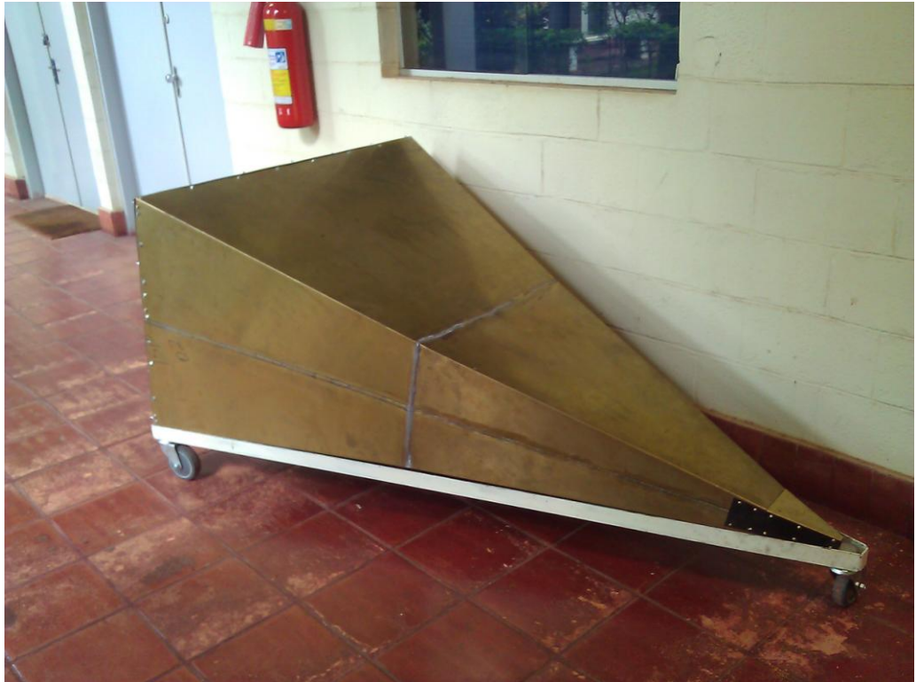
Figura B.8: GTEM montada e com terminação APEX completa.
