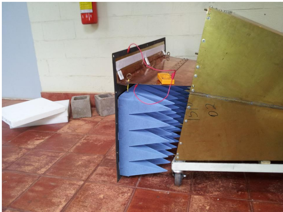
Figura B.3: RAM – cones absorvedores e terminação 50 Ohms.
