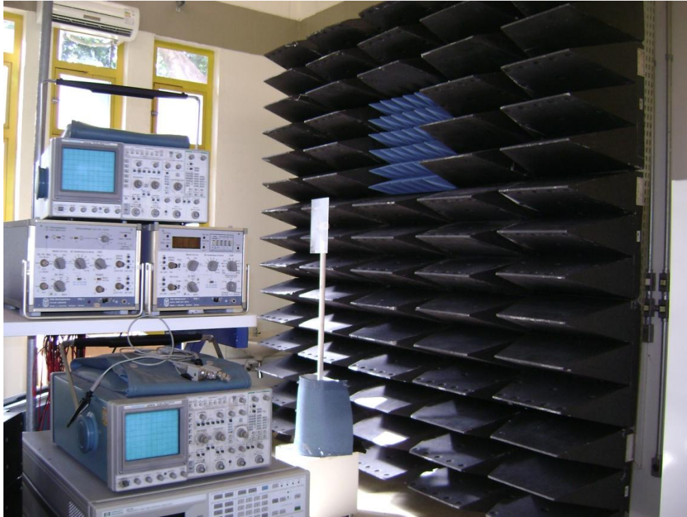
Figura 2.6: Parede com absorvedores para compor setup OATS.
