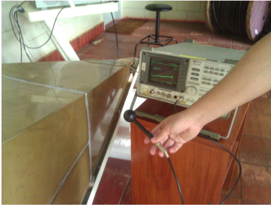
Figura B.6: Medida de vazamento de RF da GTEM.
