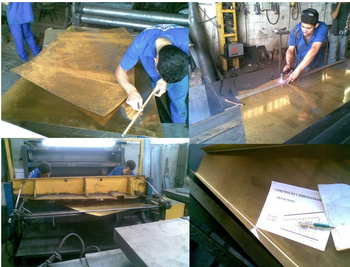
Figura 5.1: Processo de corte e dobra das chapas de latão- do alto no sentido horário: marcação da chapa de latão de acordo com projeto; corte da parte frontal do setor 2 com plasma; dobra da chapa; primeira metade do setor 2 finalizada.
