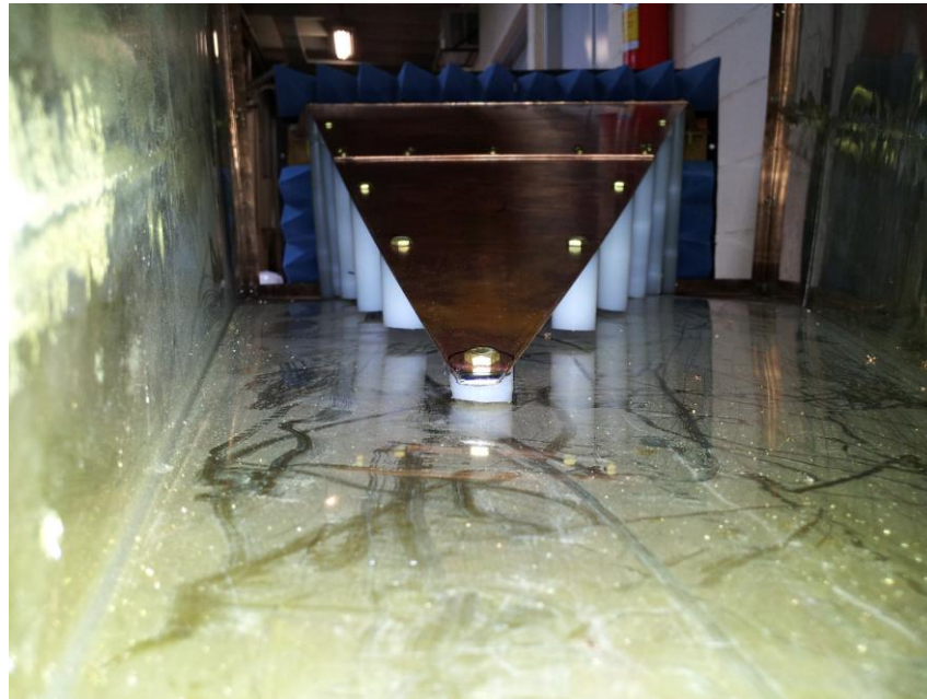
Figura B.4: Visão interna da câmara montada e septum .
