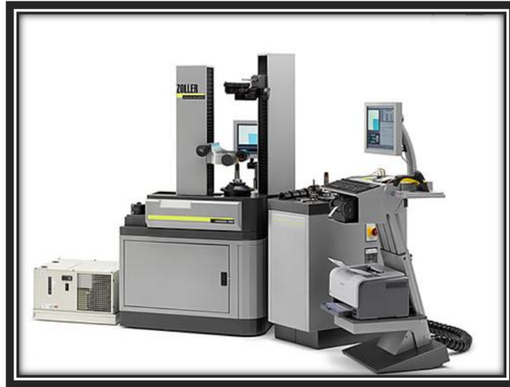
Figura 2.14 – Máquina de pré-ajustagem de ferramentas ZOLLER
