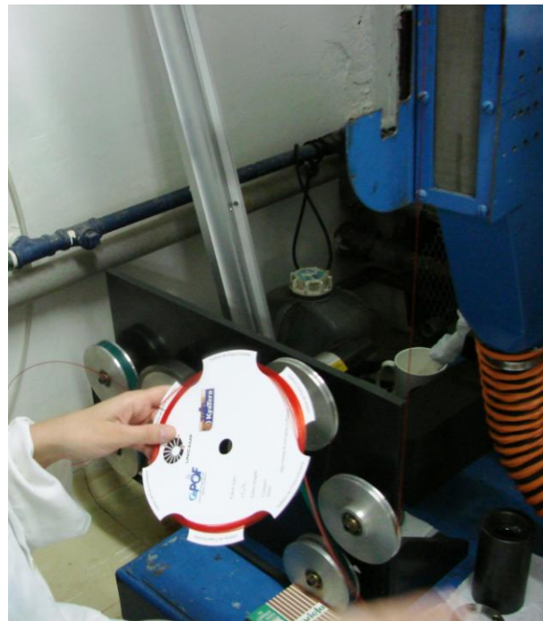
Figura 3.7: Embobinamento da FOP extrusada.
