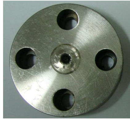
Figura 3.5: Matriz com orifício de 4 mm de diâmetro (observa-se a circunferência do orifício danificada).
