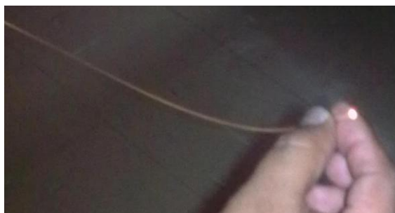
Figura 4.30: FOP produzida com núcleo de PMMA (incolor) e casca de PVDF.
