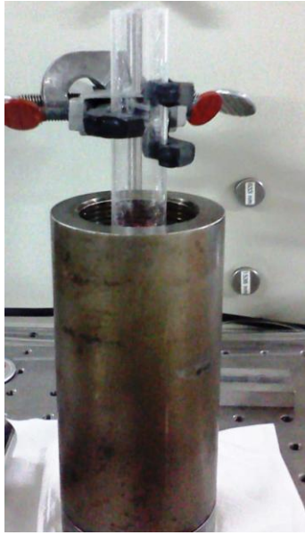
Figura 3.3: Detalhe do tubo de acrílico centralizado no cilindro de aço para inserção dos grânulos de PMMA.
