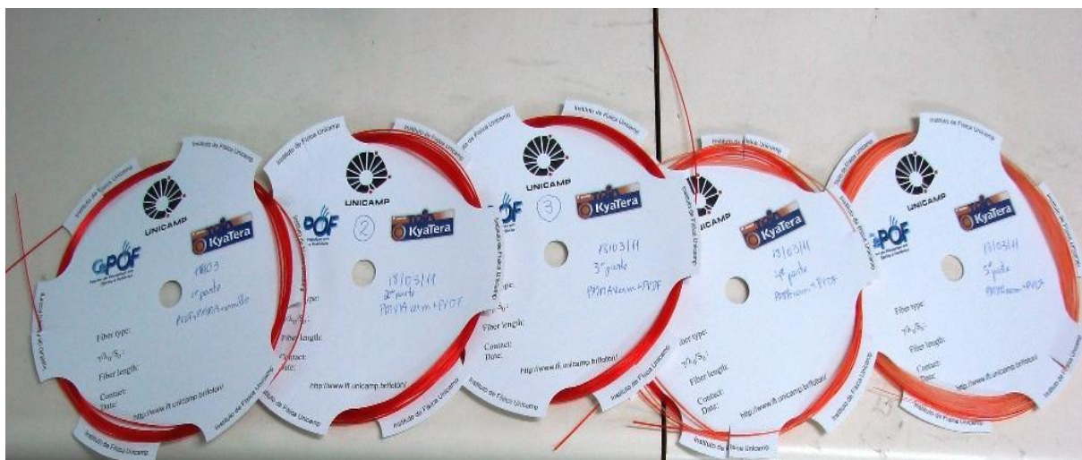
Figura 4.1: Comprimentos de fibras extrusadas com núcleo de PMMA e casca de PVDF do início (esquerda) ao fim da extrusão.
