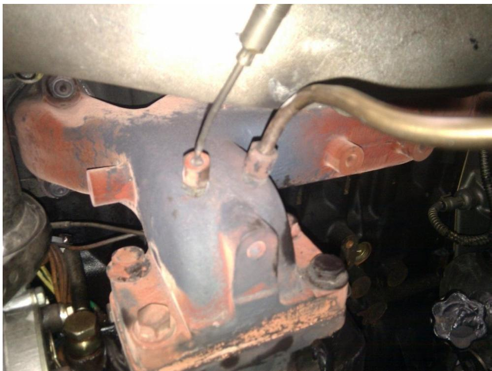
Figura 30: Instrumentação de Pressão e temperatura no coletor de escape
