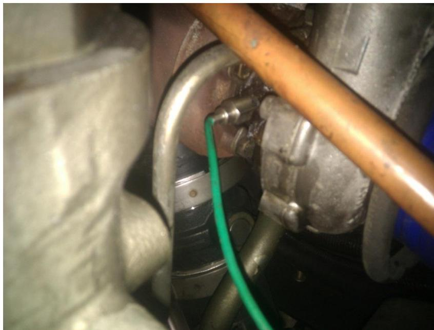
Figura 36: Sensor de rotação do eixo do turbocompressor no motor instalado no veículo
