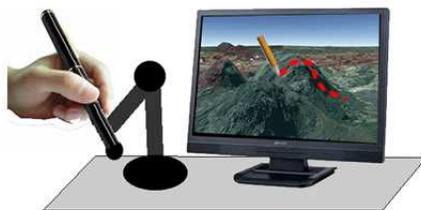
Figura 4: Um usuário utilizando dispositivo com *feedback* para desenhar sobre o mapa 3D<sup>13</sup>.
