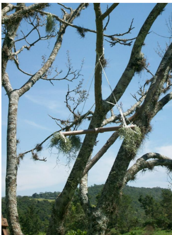
Figura 2.4. Suporte utilizado na fixação de T. usneoides . Foto tirada no ponto de amostragem do Condomínio Serra das Cabras, em Joaquim Egídio.
