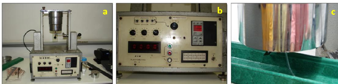
Figura 11. Processo de obtenção de filamentos por plastômetro. (a) plastômetro; (b) marcador de temperatura em  $93^{\circ}\text{C}$ ; (c) extrusão do filamento.
