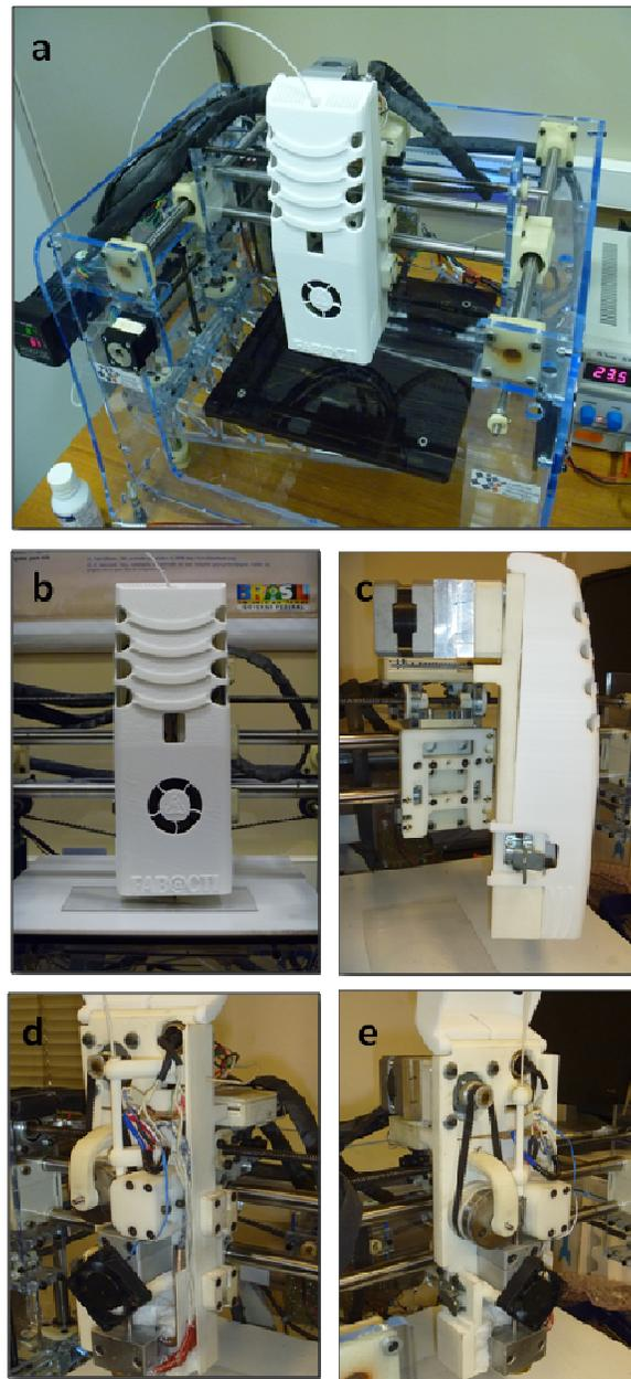
Figura 15. Fab@CTI desenvolvida no CTI (a) e seu cabeçote intercambiável (b-e).
