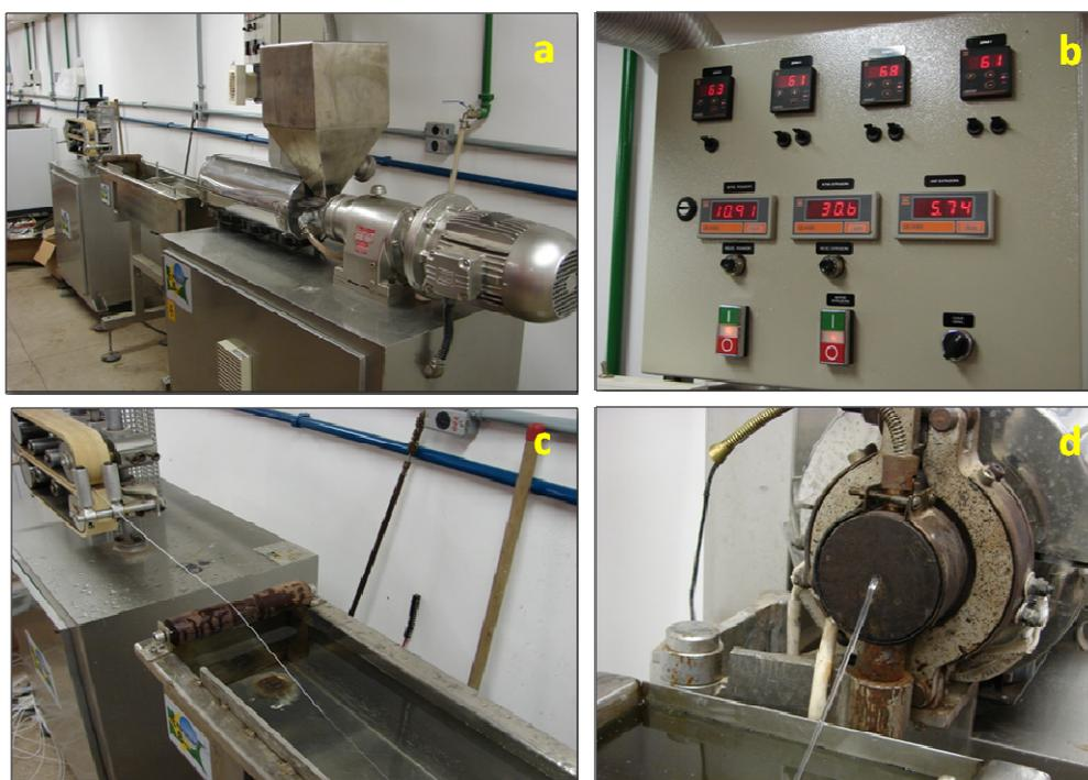
**Figura 12. Processo de obtenção de filamentos por extrusora. (a) extrusora; (b) marcador de temperatura das zonas de extrusão e velocidade do puxador mecânico; (c,d) extrusão do filamento.**
