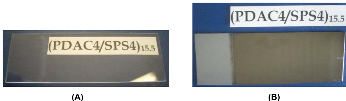
Figura 3.18. Filmes de (\text{PDAC4/SPS4})_{15,5} depositados sobre (A) vidro e (B) wafer de Si.
