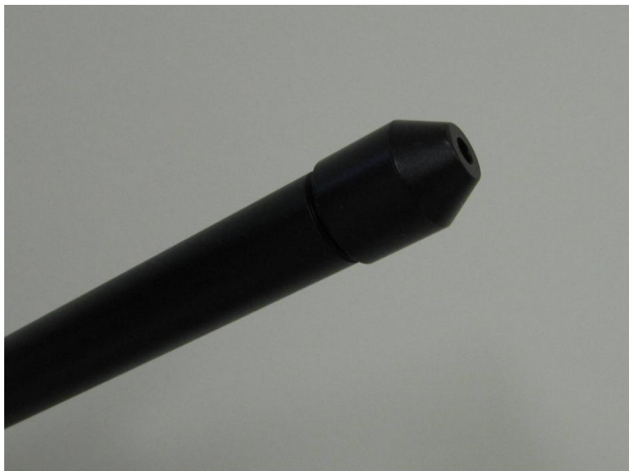
Figura 4 – Ponteira de alumínio confeccionada para proteção e manuseio das fibras ópticas.
