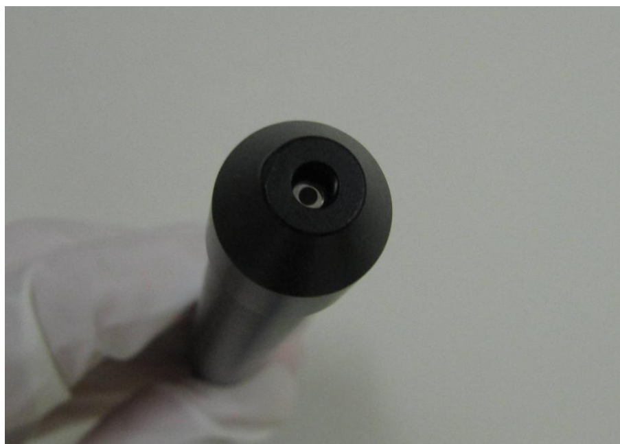
Figura 5 – Imagem da ponteira de alumínio externa à sonda de investigação protegendo-a da iluminação do ambiente.
