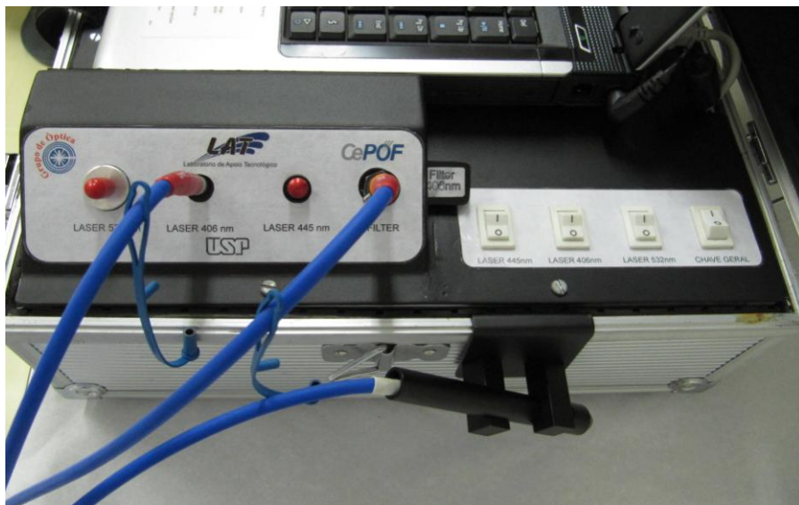
Figura 2 – Imagem da sonda de investigação com uma extremidade conectada ao laser e a outra ao espectrofotômetro.
