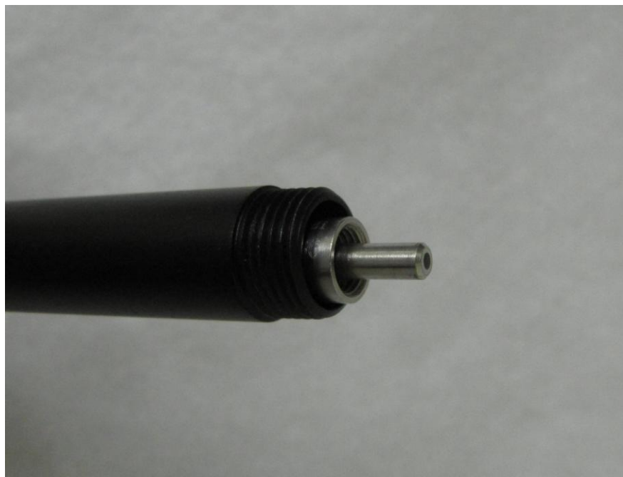
Figura 3 – Imagem da ponteira de investigação que possui uma área total de 2 mm de diâmetro.
