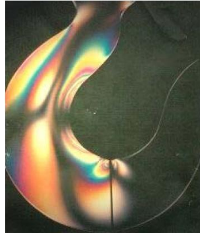
Figura 12. Exemplos de distribuição de franjas policromáticas em amostras fotoelásticas. Fonte: Spinelli, 2003.
