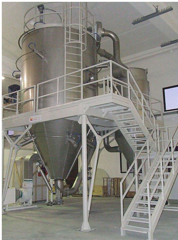
Figura 2.1 – Secador spray dryer para aplicação industrial (SPRAY DRYER & CIA, 2010).
