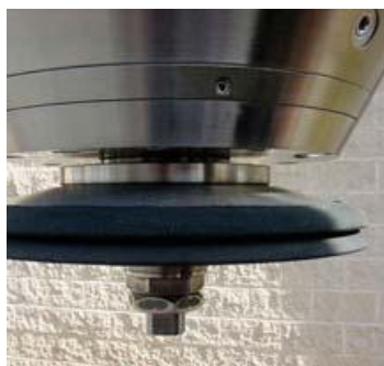
Figura 2.7 – Disco com forma de prato (NIRO, 2009).
