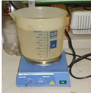
Figura 4.15: Desinfecção utilizando o agitador magnético como câmara de contato entre o desinfetante e o efluente dos filtros de areia.
