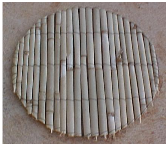
Figura 4.6: Grade suporte instalada no fundo cônico dos reatores.
