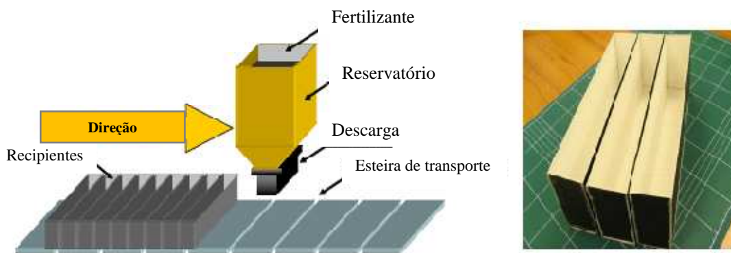
Figura 7. Esquema da bancada de testes para medir a taxa de aplicação do dosador de fertilizante. (a) bancada; (b) coletores (adaptado de YU et al., 2006).
