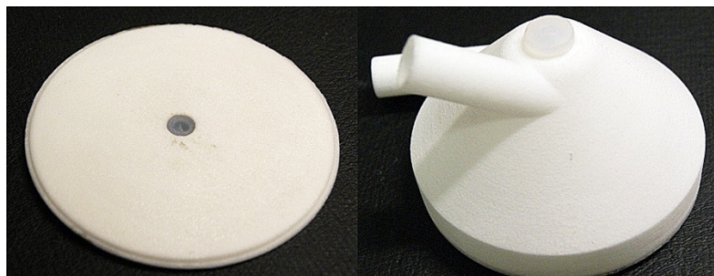
Figura 3.11 - Base do cone externo e cone externo, com mancais “fêmea” posicionados ao centro.
