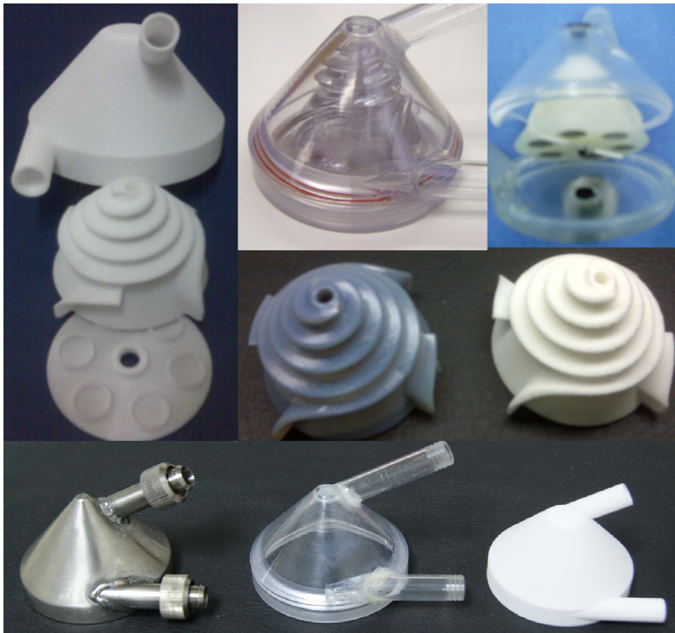
Figura 3.9 – Protótipos do rotor e cones externos da BSCI: em titânio (abaixo à esquerda), material translúcido - acrílico (abaixo, centro) e poliamida (abaixo à direita).
