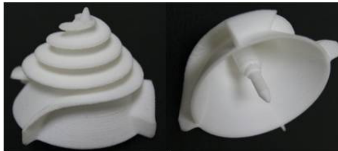
Figura 4.4 - Posicionamento do mancal macho através do rotor da BSCI.
