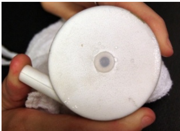
Figura 3.22 - Vazamento de água através dos poros do protótipo obtido por SLS.
