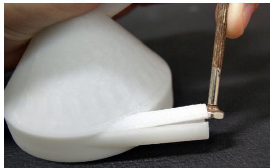
Figura 3.19 - Dano causado ao protótipo durante a remoção do material de suporte.
