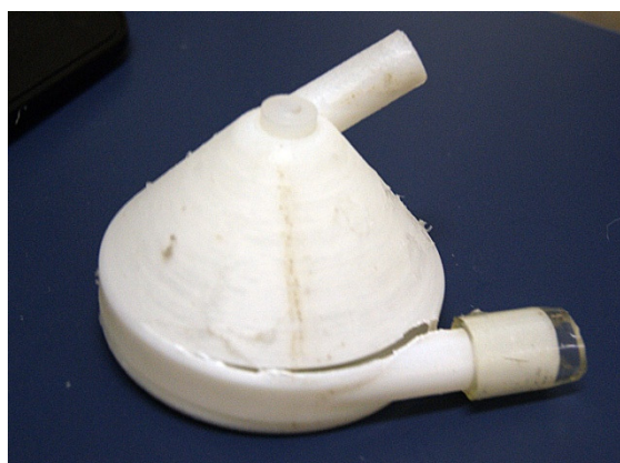
Figura 3.21 - Protótipo em ABS com a saída danificada.
