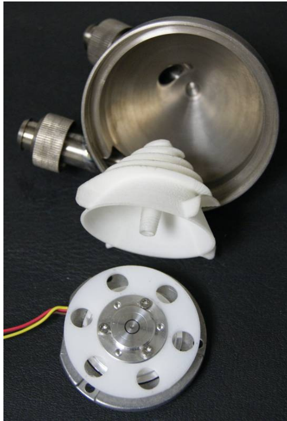
Figura 3.1 - Foto do dispositivo projetado e construído. Cone externo da BSCI em titânio, rotor em poliamida e motor BLDC.
