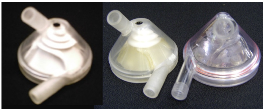
Figura 3.10 - Protótipos da BSCI em material translúcido com os rotores ao centro, confeccionados através da combinação de técnicas manuais e usinagem.
