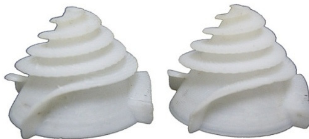
Figura 3.16 - Protótipos do rotor confeccionados em ABS por FDM.
