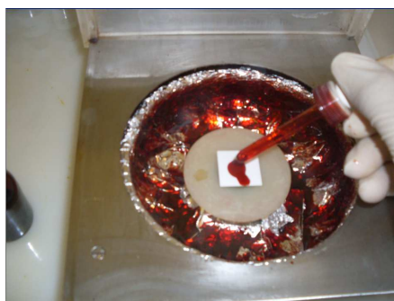
Figura 5.5 - Aplicação do fotoresiste sobre o substrato no spinner
