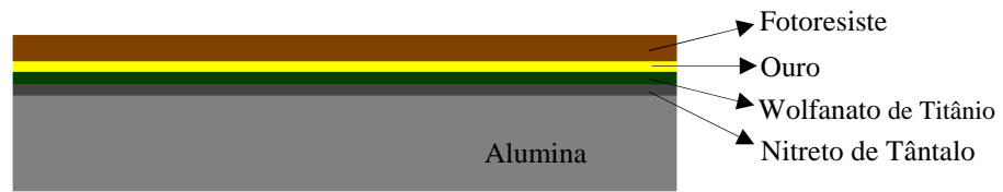
Figura 5.6 - Camadas aplicadas sobre o substrato
