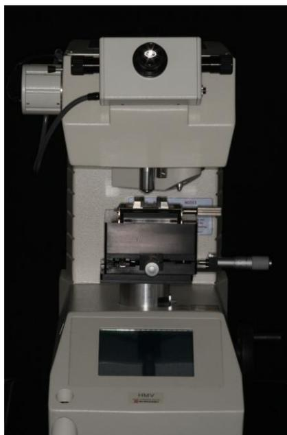
**Figura 10:** Durômetro Shimadzu.
