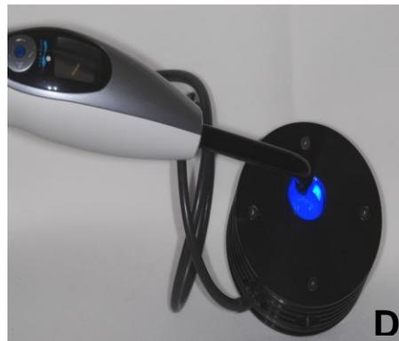
**Figura 2- A:** Paquímetro digital Mitutoyo, **B:** Potenciômetro Ophir 10A-V2-SH, **C:** Microprocessador NOVA, **D:** Avaliação da potência do aparelho fotoativador Bluephase.
