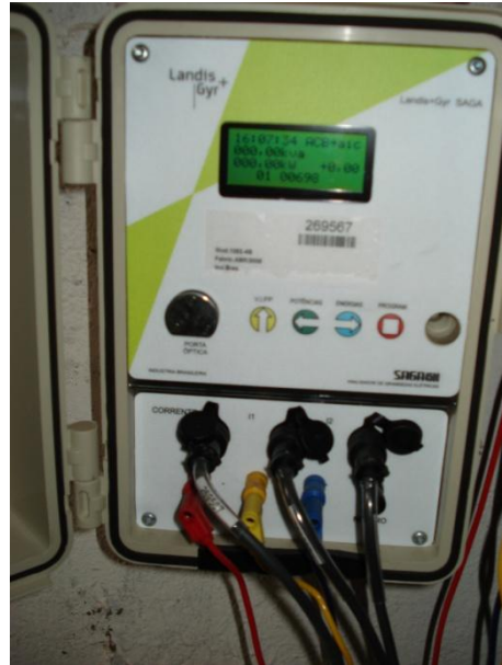
Figura 23 Analisador e registrador eletrônico de sistemas elétricos monofásicos ou trifásicos SAGA4500 AMPFLEX
