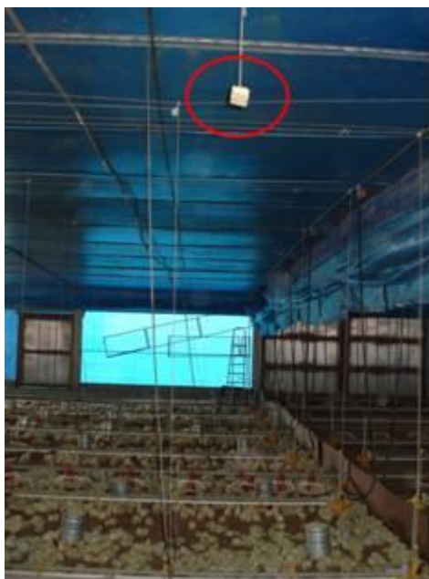
Figura 11 Datalogger Hobo® e sua instalação no centro geométrico dos quadrantes em um dos galpões.
