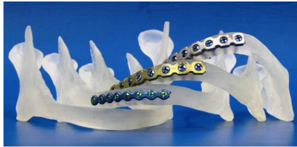
Figura 14. Modelos Fotoelásticos: controle, sistema de fixação 2.0mm com travamento, sistema de fixação 2.4mm com travamento e sistema 2.4mm Convencional.
