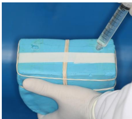
Figura 9– Aplicação da resina fotoelástica no molde.
