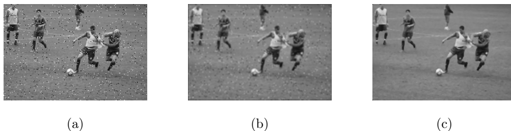
Figura 21: (a): imagem ruidosa (b): imagem filtrada pelo filtro de média (c) imagem filtrada pelo filtro de mediana.
