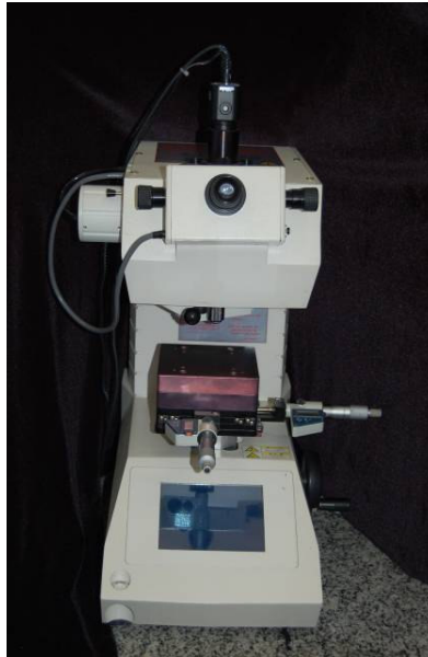
Figura 6 – Durômetro Shimadzu (modelo HMV-2, Japão)
