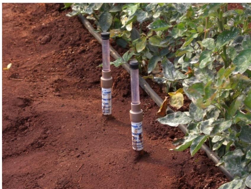
**Figura 11 - Vista dos tensiômetros de ponta porosa instalados nos canteiros da estufa de pesquisa**
