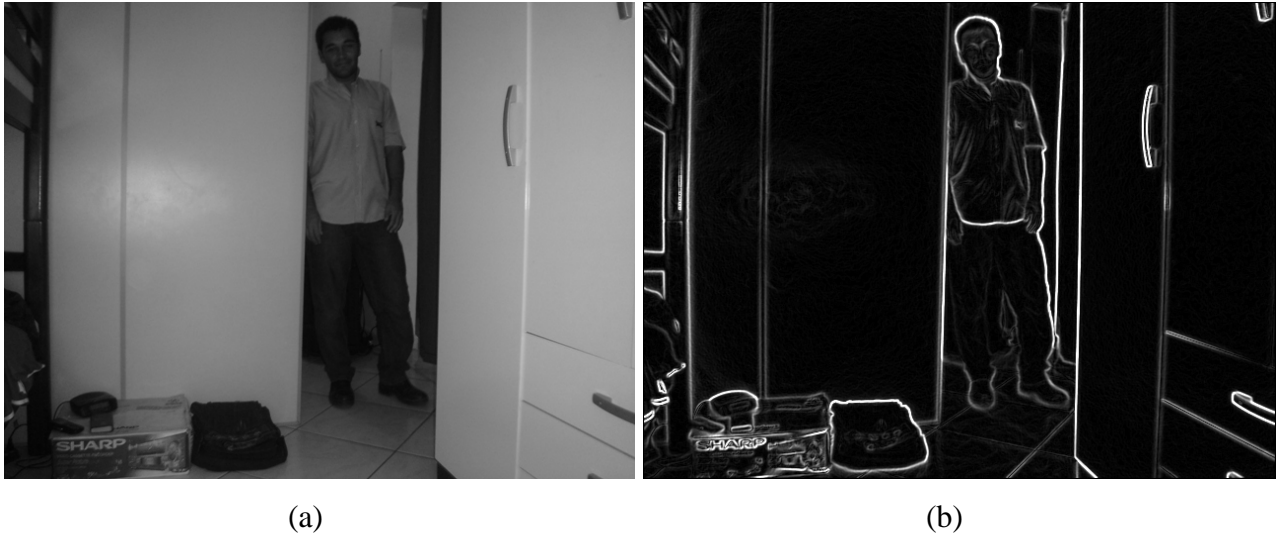
Figura 5.5: Resultado do Filtro Sobel Paralelo (a) imagem de entrada (b) Imagem resultante do filtro Sobel
