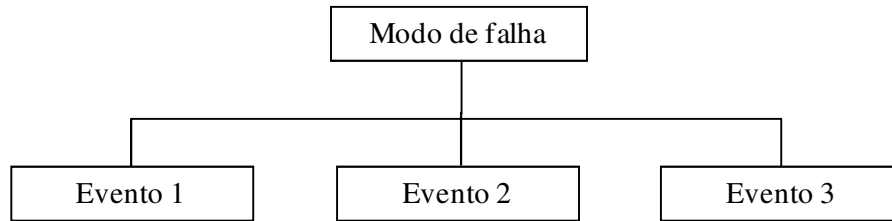
Figura 3.4. Árvore de Evento, adaptado de DNV-RP-G101, 2002.
