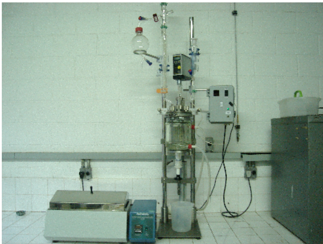
Figura 27: Reator utilizado na produção de biodiesel de gordura animal.
