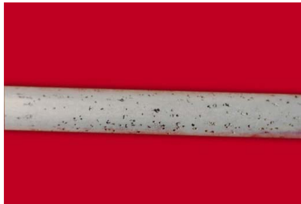
Figura 5.3 – Corrosão por pites em tubo de aço inoxidável AISI 304 [Gentil, 2003].
