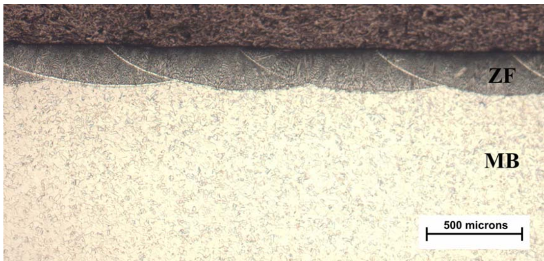
Figura 7.3 – Seção transversal do aço ASTM F 138 após tratamento de fusão por laser mostrando a zona fundida (ZF) e o material base (MB).
