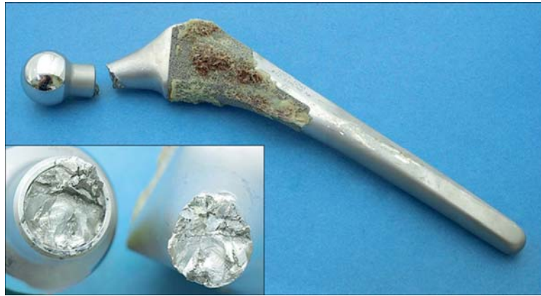
Figura 5.7 – Falha em haste femoral de liga de titânio causada por corrosão sob tensão [Lam et al., 2008].
