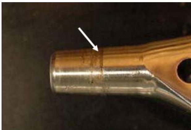
Figura 5.5 – Corrosão galvânica em uma haste femoral fabricada em liga de cobalto-cromo [Virtanen et al., 2008].
