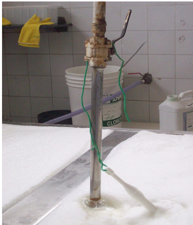
Figura 15. Aquecimento do produto com vapor direto.
