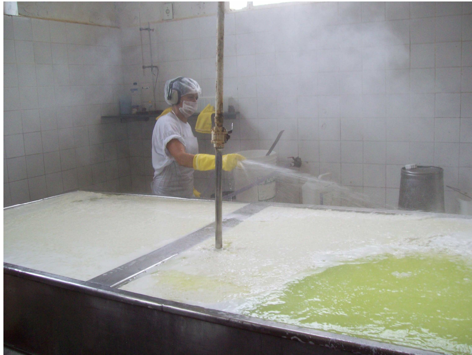
Figura 16. Retirada da espuma com jatos de água.
