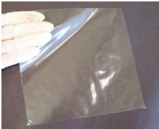
Figura 5.1. Aspecto do filme de pectina (FC1) pré-reticulado com 30 mL de solução 1% de \text{CaCl}_2 \cdot 2\text{H}_2\text{O} .
