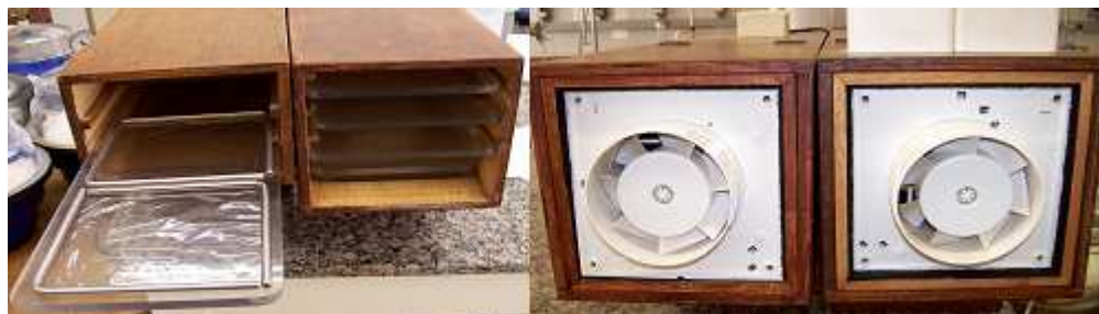
Figura 4.1. Túneis com exaustão de ar utilizados na secagem dos filmes no 2º estágio.
