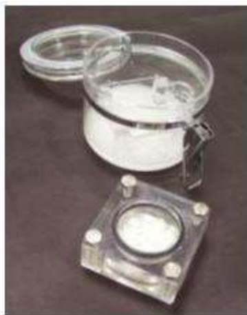
Figura 4.3. Aparato experimental utilizado para determinação da permeabilidade ao vapor de água.
